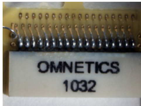
Figura 5.4 – Conector acoplado a placa de circuito impresso.
