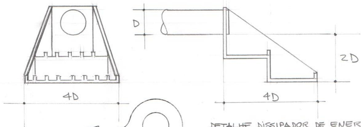
DETALHE DISSIPADOR DE ENERGIA
