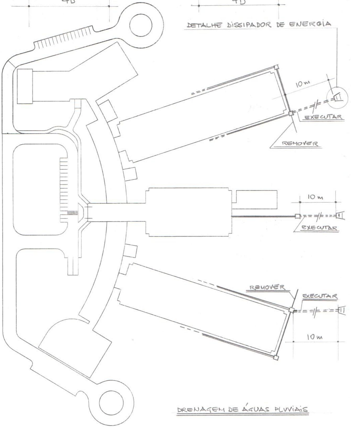
DRENAGEM DE ÁGUAS PLUVIAIS
